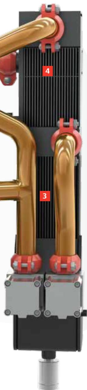
**4 RÉCHAUFFAGE :** L'air séché à un PDP de  $-20\text{ }^{\circ}\text{C}$  ( $-4\text{ }^{\circ}\text{F}$ ) est réchauffé avant de quitter le sécheur en deux étapes. Lors de la première étape, l'air pénètre de nouveau dans la partie supérieure du second échangeur de chaleur et est chauffé par l'air entrant à  $-5\text{ }^{\circ}\text{C}$  ( $23\text{ }^{\circ}\text{F}$ ), tout en maintenant un PDP de  $-20\text{ }^{\circ}\text{C}$  ( $-4\text{ }^{\circ}\text{F}$ ).
