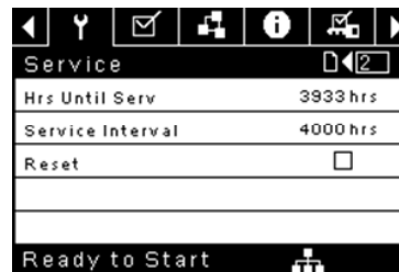
Figura 16 : Configuración De Mantenimiento
