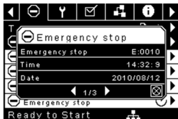
Figure 14 : Historique Des Déclenchements
